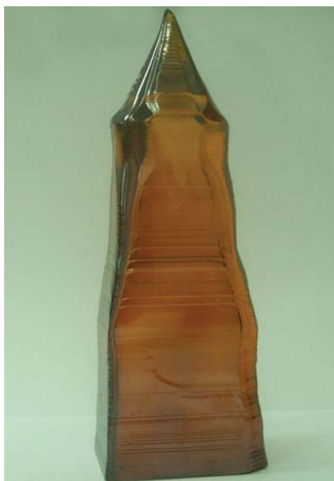
Rys. 1. Monokryształ \text{Bi}_{12}\text{GeO}_{20} otrzymany metodą Czochar-skiego przez dr inż. A. Majchrowskiego w Zakładzie Fizyki i Technologii Kryształów Wojskowej Akademii Technicznej
